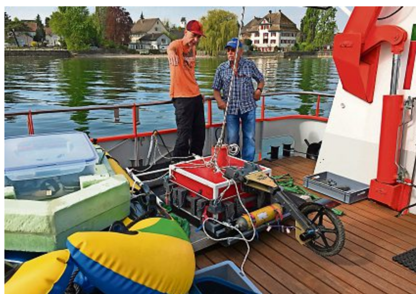
Weltweit einzigartiger Prototyp eines Unterwasser-Georadar-Geräts der Technischen Universität Darmstadt, links der Sedimentologe Jens Hornung.
